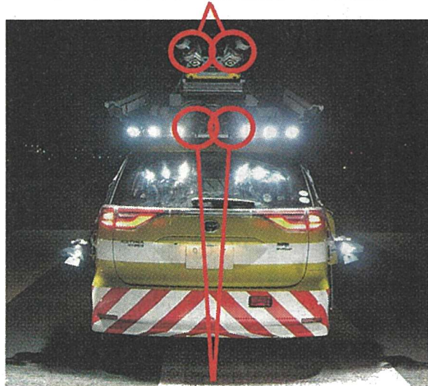
ラインセンサーカメラ(ひび割れの検出)
