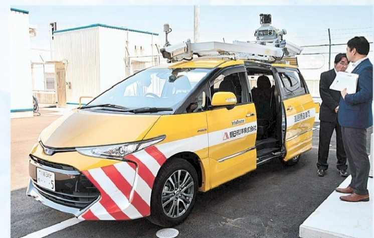
新たに導入する「インフラドクター」の計測車両。最新技術の導入で業務の効率化を進めている＝5月中旬、静岡空港
